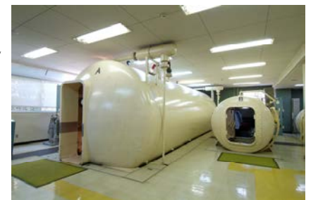
高気圧酸素治療のタンク（写真左）9人用の第二種装置
